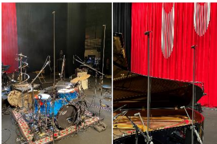
ドラム・ピアノそれぞれ左右上下に KK 184 を 4 か所ずつ設置
